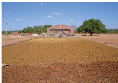
Figura 2. Fermentação semi-sólida de resíduo da indústria de suco de caju seguida de secagem ao sol.
