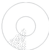
Figura 6 - Pintos agrupados num só lado do círculo (corrente de ar). Para resolver o problema, deve-se fechar as cortinas.
